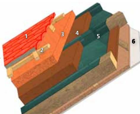
Un isolant semi-rigide flexible de type STEICO*flex* est posé entre chevrons. Dans les charpentes anciennes, les chevrons ne présentent pas une hauteur suffisante pour atteindre les performances thermiques requises de nos jours. STEICO*special dry* est un isolant qui se pose sur les chevrons, sans gêner les occupants des combles.
