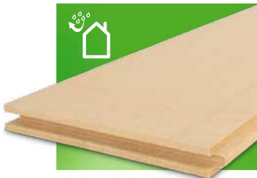
Lors de la rénovation d'une toiture par l'extérieur, il est nécessaire de protéger des intempéries l'espace d'habitation situé sous le toit le plus rapidement possible. Le panneau rainure et languette STEICOspecial dry est un écran rigide de sous-toiture pour des pentes de toit supérieures à 16°. Pour des pentes inférieures, il est nécessaires d'adopter des dispositions particulières.
